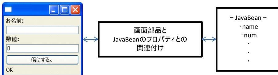
JFace Data Binding を使用しない場合はデータが変更になるイベントごとにデータの同期を行うよう作成する必要があることを示しています。それに対して JFace Data Binding を使用する場合は画面部品と JavaBean のプロパティを関連付けるようになっています。
